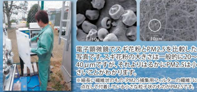
電子顕微鏡でスギ花粉とPM2.5を比較した写真です。スギ花粉の大きさは一般的に20~40μmですが、それよりはるかにPM2.5は小さいことがわかります。
