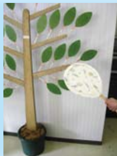
風を送ると、リーフに固定したLEDが点灯
