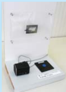
スイッチを押すと、板状のスピーカーから音楽を発信
