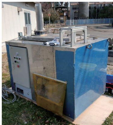
今回使用した微生物処理装置
