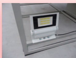
130WのLED照明（負荷のため）
