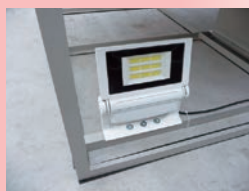
130WのLED照明(負荷のため)
