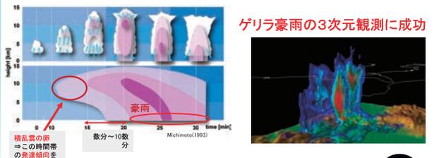
フェーズドアレイ気象レーダが局地的に急発達する積乱雲を3次元に観測した様子
