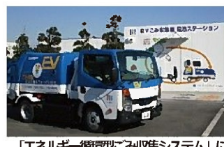
「エネルギー循環型ごみ収集システム」 によるEVごみ収集車（電池交換型）の導入
